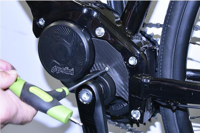
Die Kunststoffabdeckung ausbauen, den Aluminiumdeckel abnehmen und das Kabel richtig herum in die Buchse stecken.
