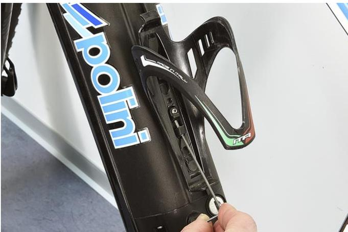
Den Flaschenhalter an den Halterungen anbringen und mit dem mitgelieferten Schlüssel die Gewindeschraube zudrehen, bis die Laschen der Halterung am Akku anliegen und der Flaschenhalter nicht mehr in der Führung verrutscht.
