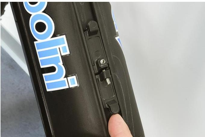
Die Trinkflaschenhalterungen in die hierfür vorgesehene Aufnahme am Akku einsetzen.
