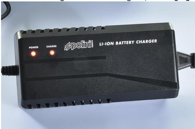
Am Stromnetz angeschlossenes Ladegerät, Akku **aufgeladen (Ladevorgang beendet)** - LED Power ROT / LED Charge GRÜN
