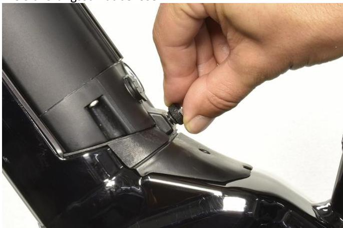
2. Den Schlüssel in den Zylinder an der Akku-Halterung stecken.
