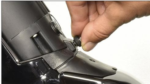
2. Introducir la llave en el cilindro sobre el soporte de la batería.
