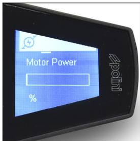
Ejemplo de pantalla de potencia del motor. Muestra la potencia suministrada por el motor eléctrico de la bicicleta a pedalada asistida en forma de porcentaje con respecto a la potencia máxima.
