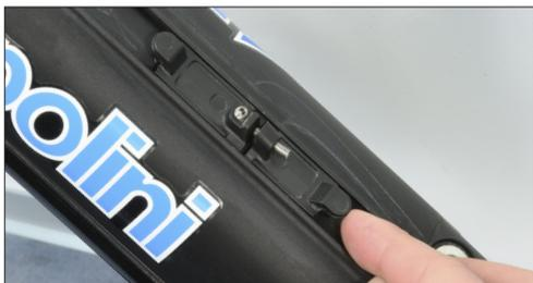
Apoyar el portabotella en los soportes y, con la llave incluida de serie, apretar el perno hasta que las lengüetas de enganche del soporte se fijen en la batería y el portabotellas no se deslice por la guía.
