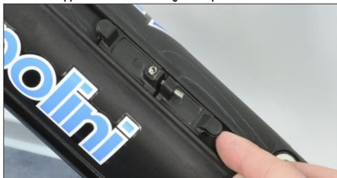
Déposer le porte-bidon sur les supports et, avec la clé fournie, visser la vis sans tête jusqu'au moment où les languettes d'accrochage du support se fixent sur la batterie et le porte-bidon ne glisse plus dans le logement.
