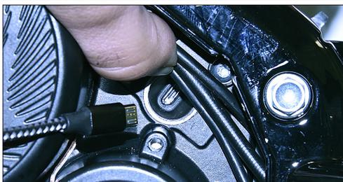
Les firmwares mis à jour sont disponibles sur le site [www.poliniebike.com](http://www.poliniebike.com). En plus du firmware, il est possible (avec le câble connecté au moteur) de télécharger un logiciel permettant de modifier le côté de montage du cyclo-ordinateur droit ou gauche et, en cas de variations de la mesure du pneu, d'étalonner la détection de la vitesse.
