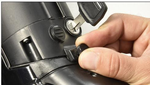
**⚠ DANGER** - Le vélo NE doit PAS être utilisé avec la clé insérée afin d'éviter toute chute de la batterie et perte de la clé.
