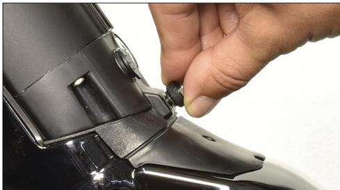
2. Introduire la clé dans le cylindre sur le support de la batterie.
