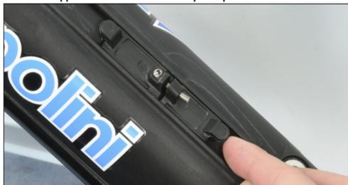
Appoggiare il porta borraccia sui supporti e con la chiave in dotazione avvitare il grano fino a quando le linguette di aggancio del supporto non si fissano sulla batteria e il porta borraccia non scorre più nella guida.
