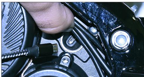
I firmware aggiornati sono disponibili sul sito [www.poliniebike.com](http://www.poliniebike.com). Oltre al Firmware è possibile (con il cavo collegato al motore) scaricare un software in cui è possibile modificare il lato del montaggio del display destro o sinistro, e in caso di variazioni sulla misura del pneumatico tarare il rilevamento della velocità.
