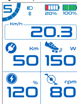
Page Fitness Moyenne (affiche la moyenne des valeurs enregistrées à partir de la dernière réinitialisation du trajet). Pour réinitialiser les valeurs de la page appuyer longtemps sur le bouton BAS ↓ ou utiliser la voix appropriée dans le menu.
