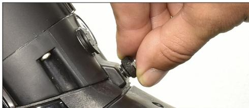
2. Introduire la clé dans le cylindre sur le support de la batterie.
