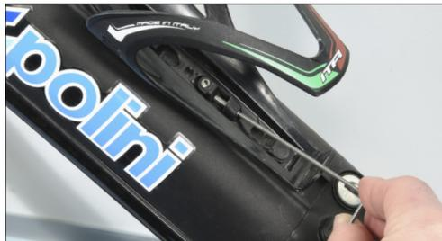
Pour plus de sécurité, serrer délicatement la vis sans tête supérieure. Le support bidon est un produit breveté Polini.
