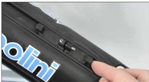
Déposer le porte-bidon sur les supports et, avec la clé fournie, visser la vis sans tête jusqu'au moment où les languettes d'accrochage du support se fixent sur la batterie et le porte-bidon ne glisse plus dans le logement.
