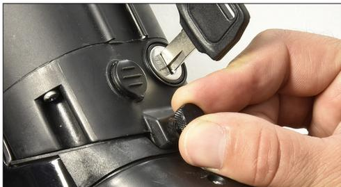
⚠ **DANGER** - Le vélo NE doit PAS être utilisé avec la clé insérée afin d'éviter toute chute de la batterie et perte de la clé.
