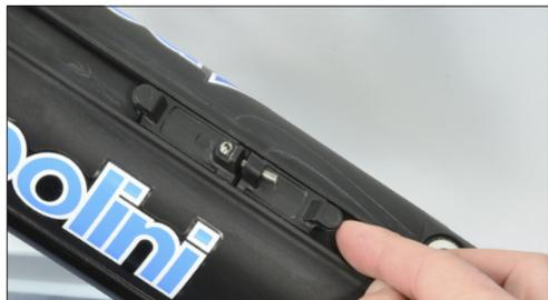
Appoggiare il porta borraccia sui supporti e con la chiave in dotazione avvitare il grano fino a quando le linguette di aggancio del supporto non si fissano sulla batteria e il porta borraccia non scorre più nella guida.
