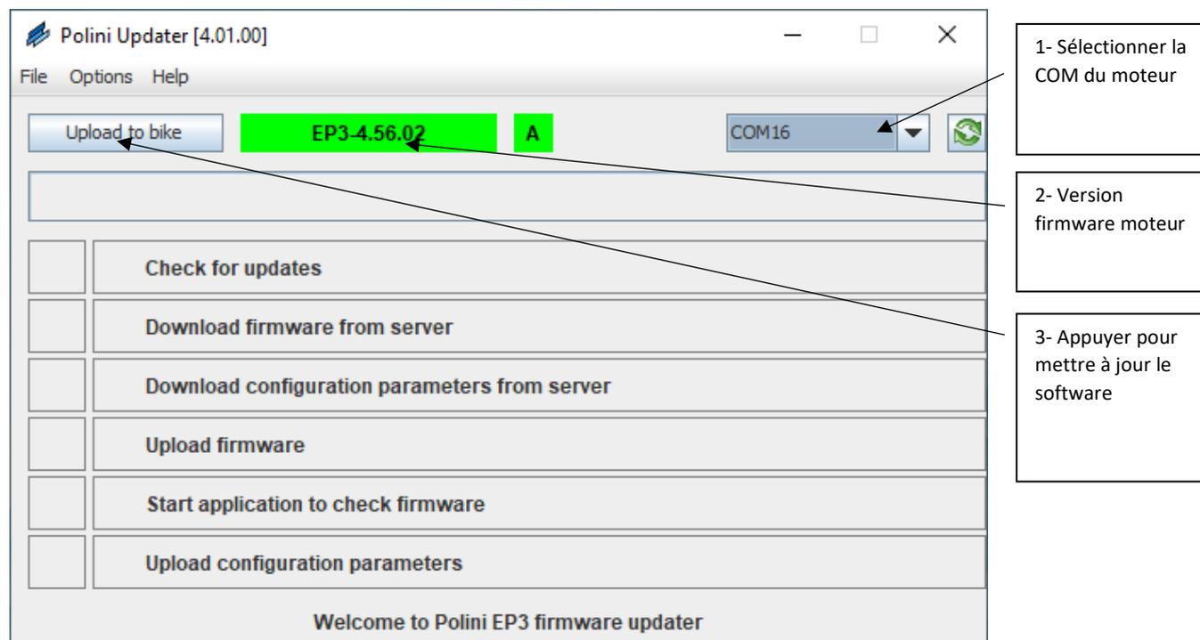
Le programme visualise la version firmware installée sur le moteur. Appuyer sur le bouton en haut à gauche « Upload to bike ». Si en ligne est présente une nouvelle version du firmware, ceci se met à jour automatiquement ; autrement sur le moteur il y a la dernière version du firmware disponible. Une fois complétée la mise à jour, déconnecter le câble USB, éteindre et rallumer le vélo.
