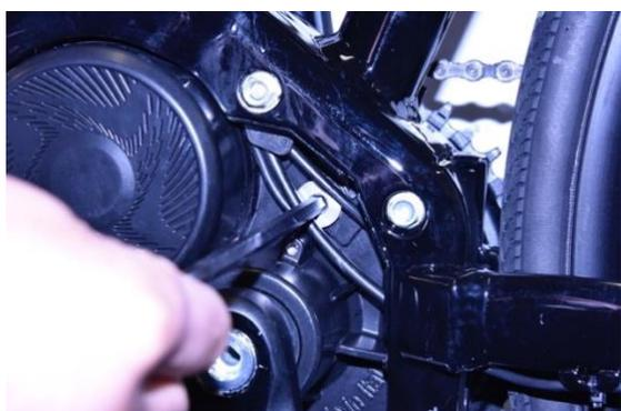
Retire le bouchon en aluminium avec une clé Allen CH 6
