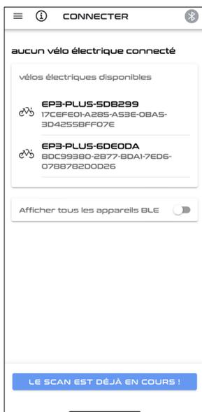
Pour associer le capteur Cardio, s'assure que le dispositif soit actif et, ensuite, appuyer le bouton Scanne ; une fois qu'il apparait dans la liste des capteurs cardio disponibles, le sélectionner pour le connecter.
