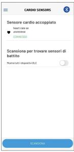
L'associazione del sensore cardio è necessaria solo la prima volta, successivamente si connetterà automaticamente al sistema E-P3+.
