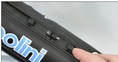
Coloque el portabotellas en el soporte y utilice la llave suministrada para enroscar el tornillo prisionero hasta que las lengüetas de enganche del soporte encajen en la batería y el portabotellas deje de deslizarse en el raíl.
